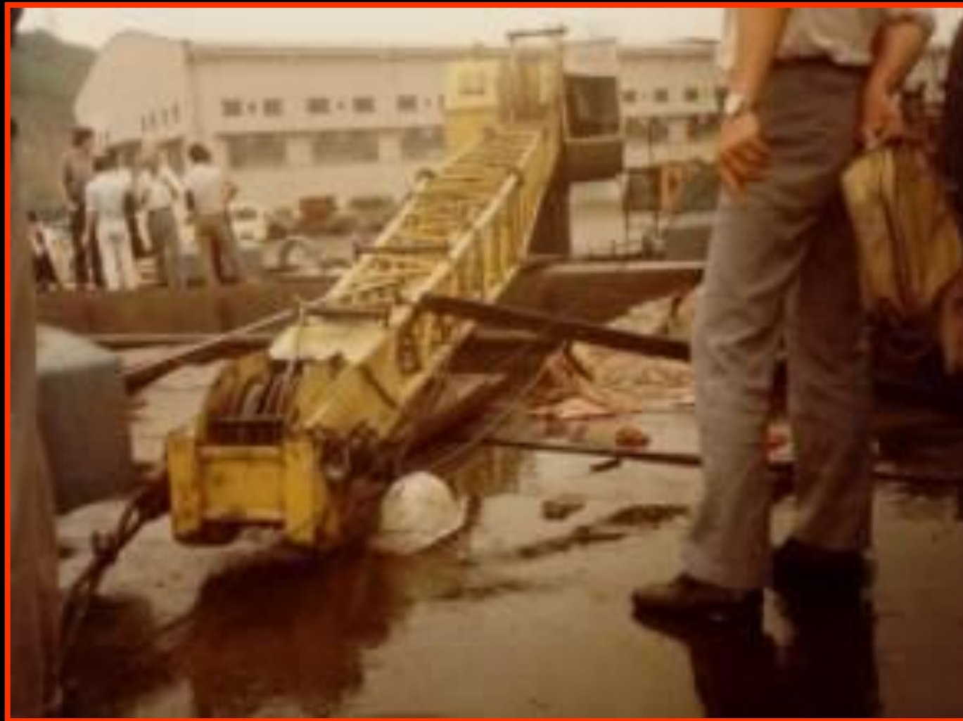
吊车的悬臂未经检查，发生断裂事故
