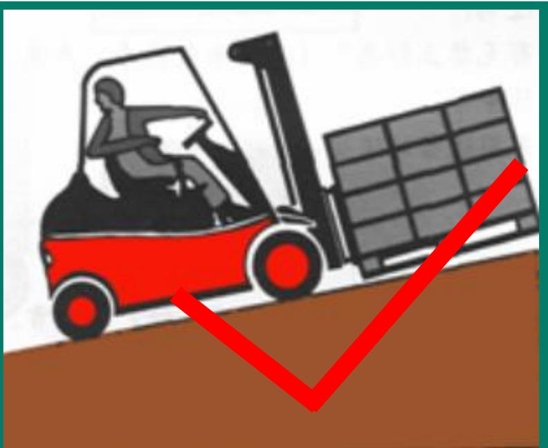
防止货物倾倒的下坡方式
