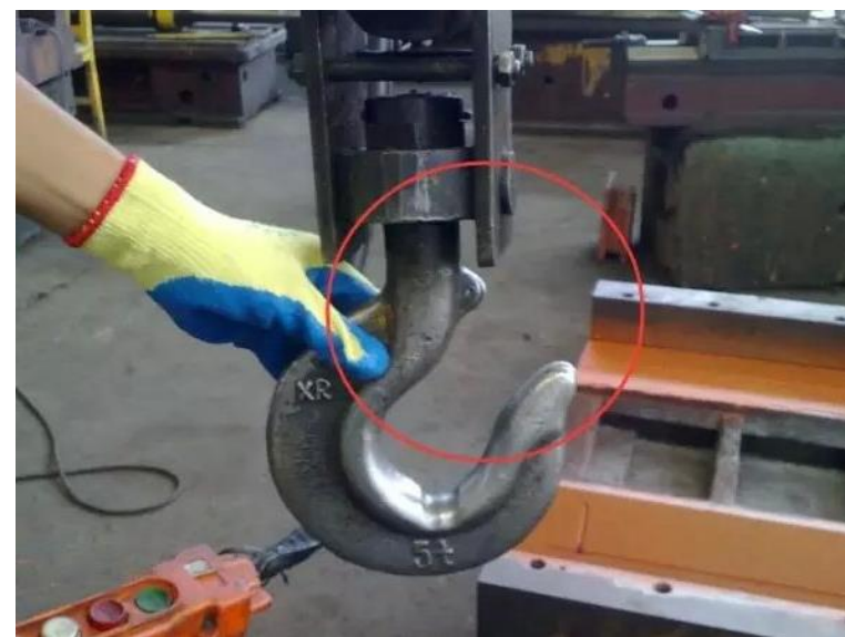
吊钩无防脱钩装置
